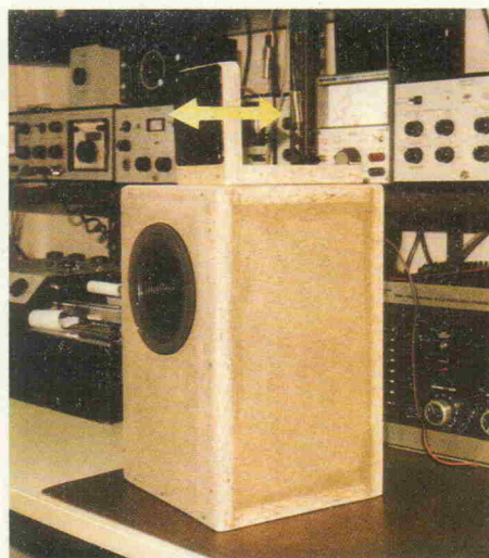
Abb. 3.2 Versuchsanordnung zur Ermittlung des Chassis-Versatzes
