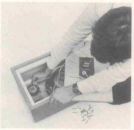
Bild 21. Weiche mit Lautsprechern verbinden
