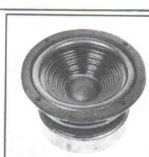
WSP 13 S: Kompakt-Tiefenlautsprecher in HiFi-Qualität mit Polypropylen-Membran, große Partialschwingungsfreiheit, sehr breitbandig einsetzbar, 45/55 W, 30-6000 Hz, 131 mm Ø
