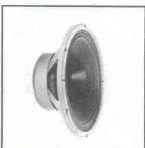
FR 31: Orchesterlautsprecher mit Hochtongel, besonders hoher Wirkungsgrad, 60/80 W, 40-17000 Hz, 300 mm Ø
