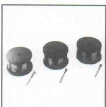
LR-Kupferspulen: Auf Ferrit-Rollenkern mit 65 mm Ø, Drahtstärke 1,3 mm Ø, Belastbarkeit 300 W, extrem geringe Innenwiderstände, z. B. LR 10 mH 0,46 Ohm
